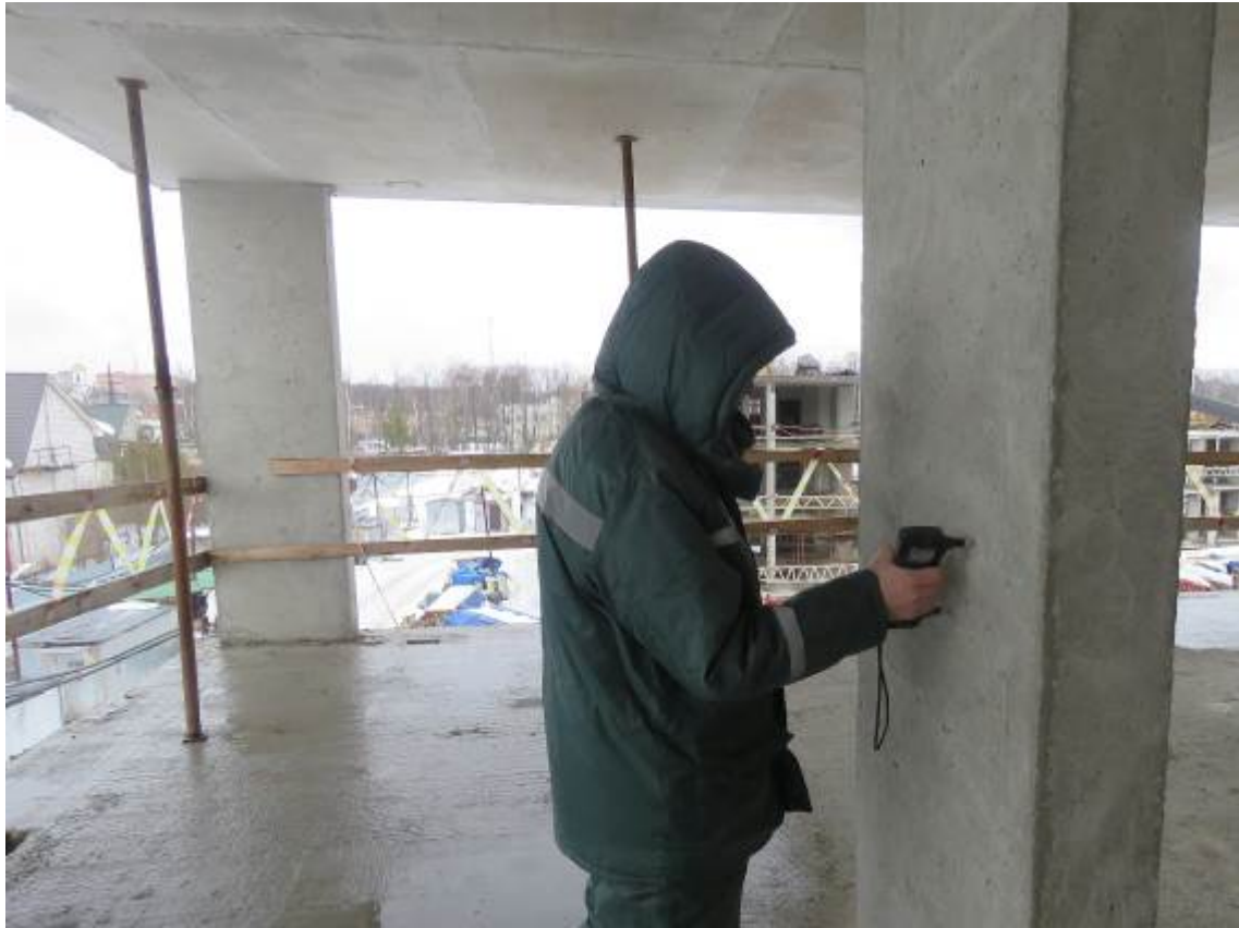
Рис. 4.3.1. Определение скорости ультразвука в монолитном железобетонном пилоне четвёртого этажа ультразвуковым методом прибором «УК 1401»
