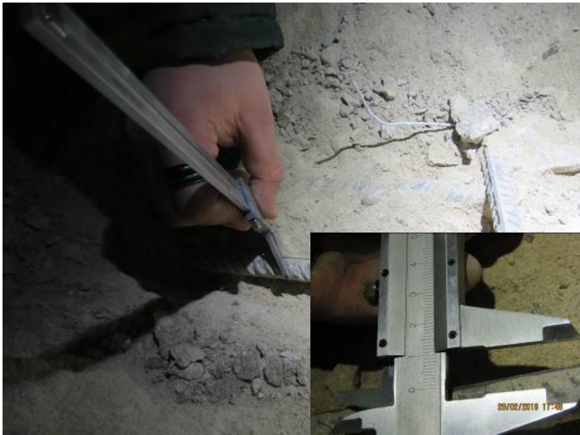
Рис. 3.1.8. (а, б) Замер диаметра верхнего армирования фундаментной плиты в осях 11/2-12/2/Л/2-М/2
