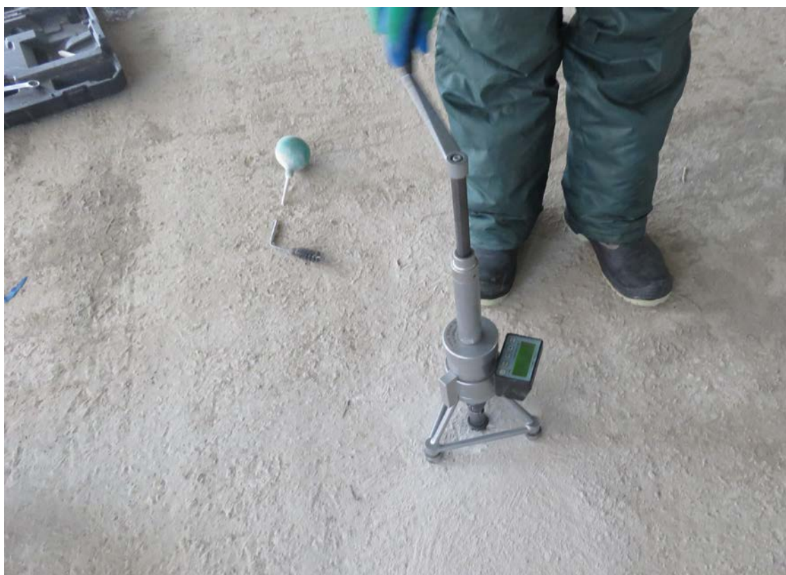
Рис. 4.2.12. Испытание бетона в монолитной железобетонной плите перекрытия третьего этажа в осях 12/1-14/1/А/1-Б/1 методом отрыва со скалыванием прибором «ПОС 50МГ-4»
