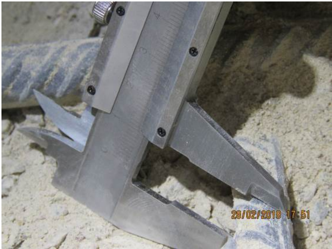
Рис. 3.1.11. (а, б) Замер диаметра арматурных стержней фундаментной плиты в осях 2/2-3/2/Б/2-В/2
